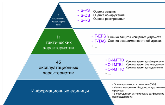
Рис. 6. Иерархия характеристик кибербезопасности EPRI
