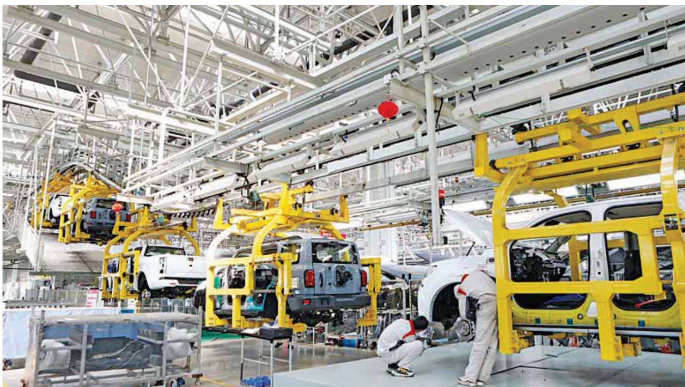
Operazione di rinforzo manuale delle viti nella fase finale di assemblaggio nella Great Wall Motors a Chongqing, provincia cinese del Sichuan, 13 marzo 2023 (fot. CFOTO/Future Publishing/Getty Images)
